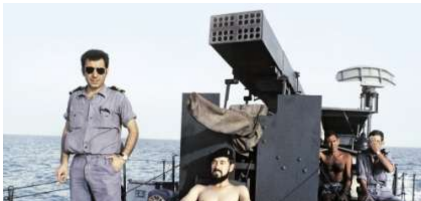
Lancha de Fiscalizaçã Pequena, com fuzileiros a bordo e uma instalação de roquetes adaptada
